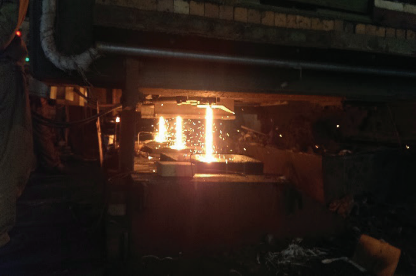
Các nguồn Cs-137 đo mức thép lỏng ở các khuôn đúc phôi thép trong Nhà máy Thép Hòa Phát.
