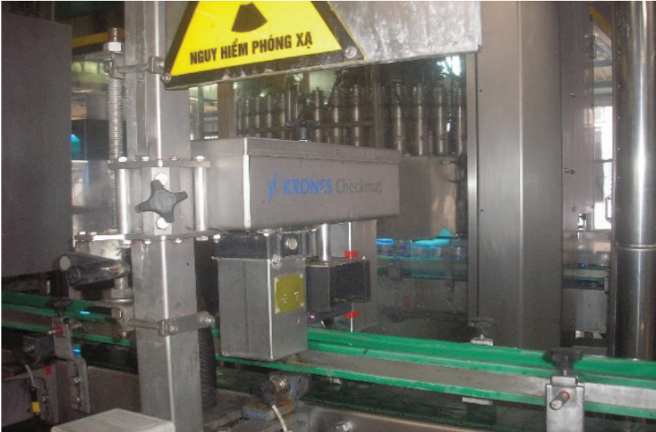
Sử dụng nguồn Am-241 trong thiết bị đo mức chất lỏng trong chai bia tại Công ty Trách nhiệm hữu hạn VBL Tiền Giang.
