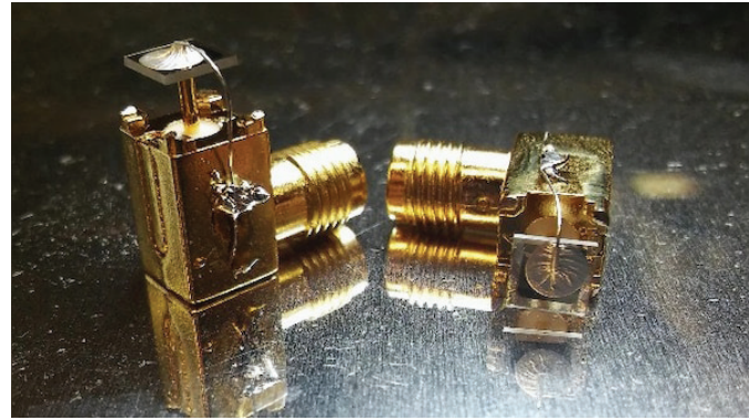
Nguyên mẫu pin gammavoltaic của Arkenlight, trong đó chuyển đổi năng lượng từ tia gamma trong chất thải hạt nhân thành điện năng.
