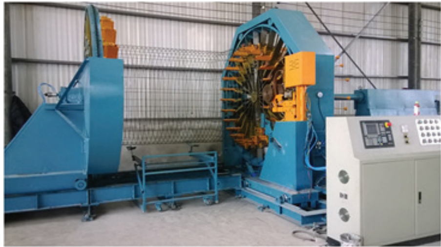
Máy hàn cốt thép ống cống bê tông điều khiển CNC đường kính 0,3-4,5%.
