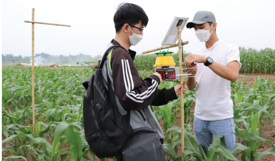
Lắp đặt hệ thống bẫy sâu keo mùa thu thông minh trên ruộng ngô, sử dụng truyền thông LoRa để truyền tải dữ liệu theo thời gian thực tại Việt Nam.
