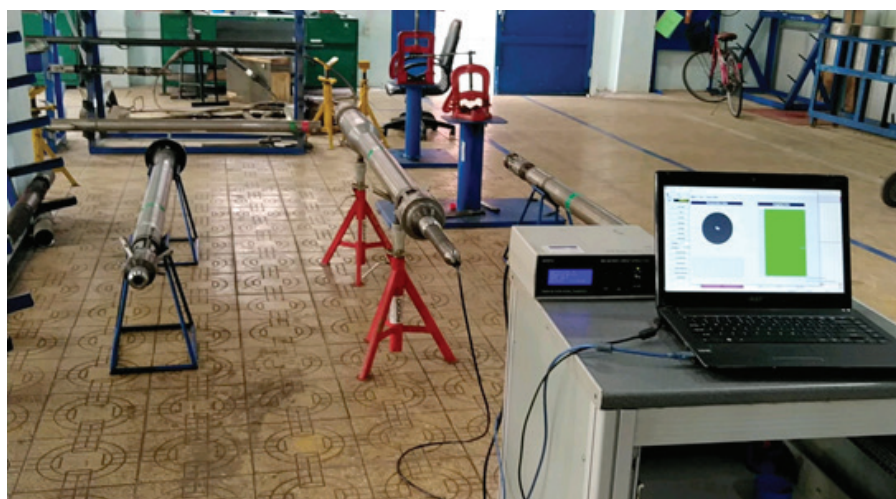
Trạm đo carota tổng hợp xách tay do các nhà khoa học Xí nghiệp Địa vật lý Giếng khoan nghiên cứu, chế tạo.
