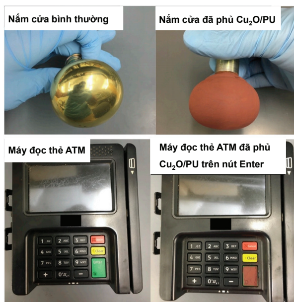
Hình 5. Ảnh chụp một số vật dụng trước và sau khi phủ màng mỏng \text{Cu}_2\text{O}/\text{PU} .
