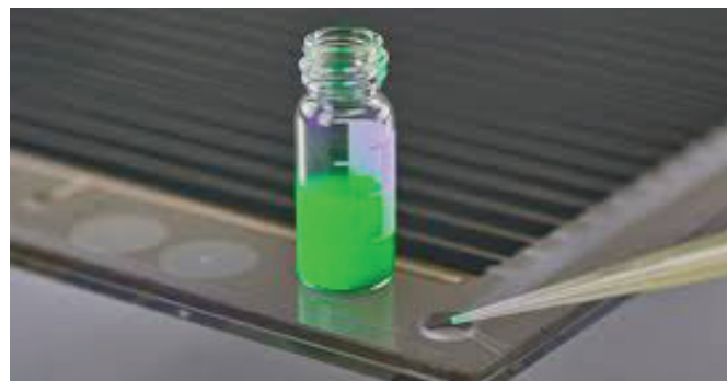
Hình 6. Chế tạo pin mặt trời perovskite bằng cách in. Giữa là lọ hóa chất dùng làm mực in.
