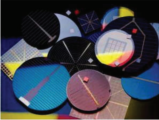
Hình 2. Các kiểu pin mặt trời thế hệ 1.
