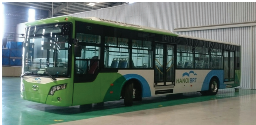
Mẫu xe buýt nhanh BRT (mẫu thực) được Thaco phát triển theo công nghệ tạo mẫu nhanh.
