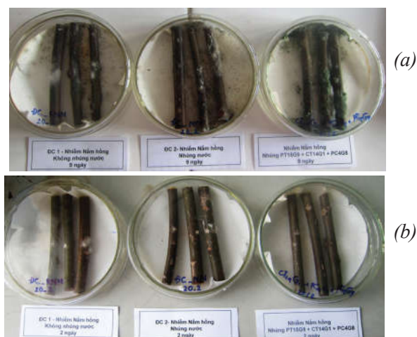
Hình 6: nấm hồng phát triển trên thân cao su khi xử lý hoặc không xử lý hỗn hợp PT15G9 + CT14G1 + PC4G8: (a) sau 2 ngày; (b) sau 9 ngày
