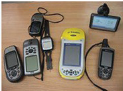
Các thành phần của hệ thống định vị và máy thu GPS cầm tay
