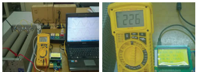
Hình 10: chạy thử nghiệm với tải thuần trở
