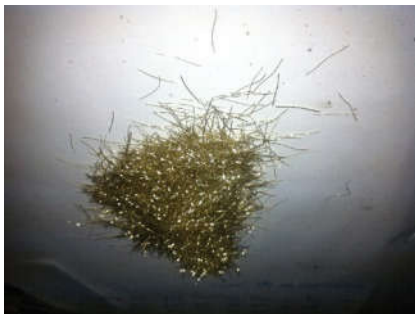
Hình 1: sợi thép thẳng mịn đồng đường kính 0,2 mm, chiều dài 13 mm của Hãng Berker
