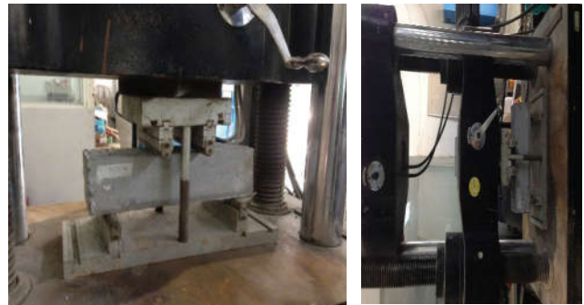
Hình 8: sơ đồ uốn dầm 4 điểm theo ASTM C1-018
