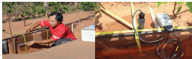
Hình 2: quan trắc diễn biến lan truyền thấm tại mô hình thực nghiệm (tỉnh Bình Thuận)
